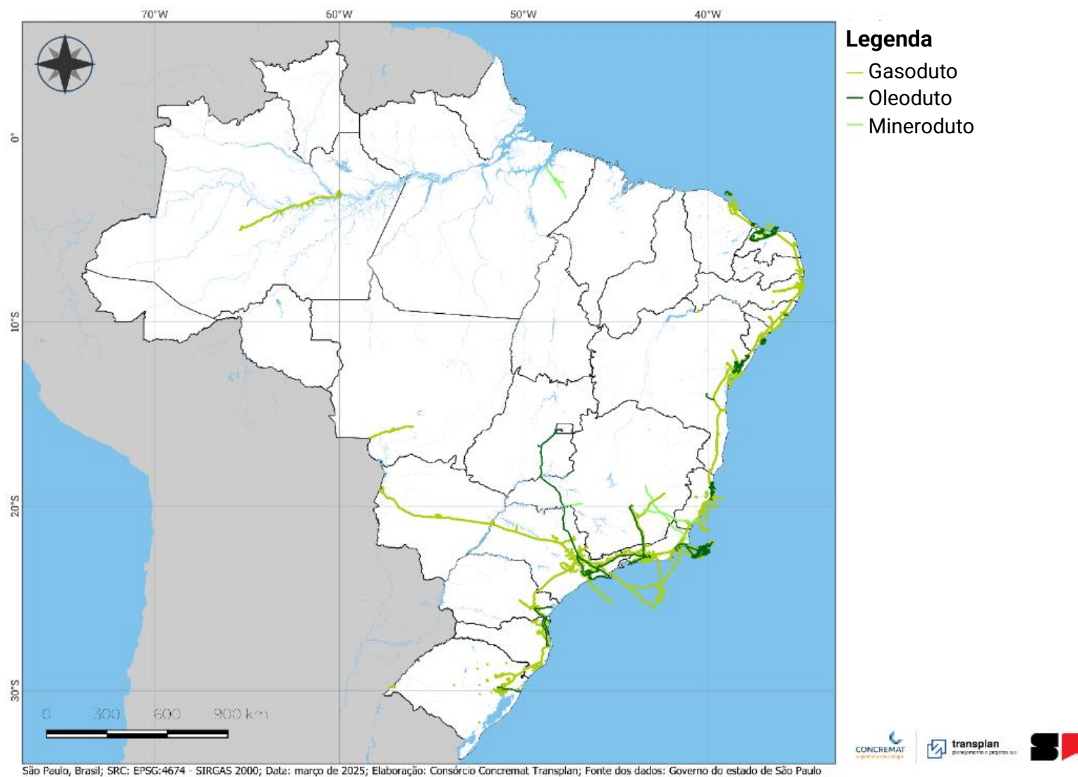
Figura 6.1 - Malha Dutoviária Nacional
