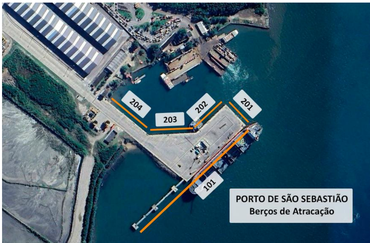
Figura 3.49 – Detalhamento da infraestrutura de acostagem do Porto de São Sebastião
